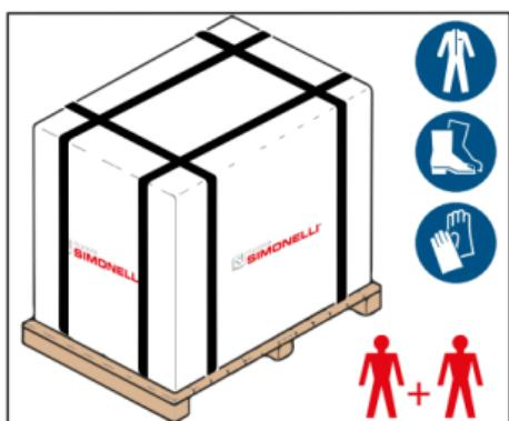
Транспортировка кофемашины выполняется вместе с другими кофемашинами на поддоне в ящиках, которые крепятся к поддону крепежными лентами.
