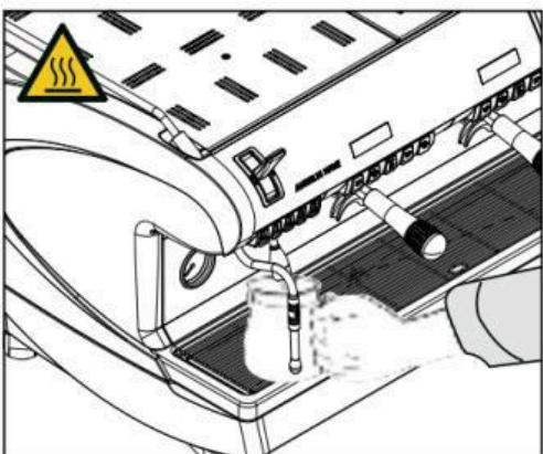
Горячая вода из трубы подается в течение запрограммированного времени. Для остановки подачи горячей воды нажмите повторно на кнопку.
