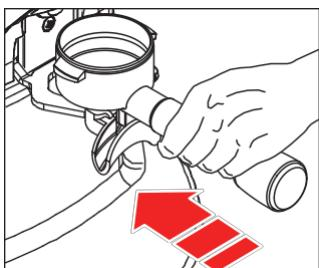
Выберите однократную или двукратную дозу с помощью соответствующих кнопок (C) или (D). Установите держатель фильтра на вилку (6) и вставьте его в фиксатор держателя фильтра, толкните его вперед, пока он не коснется кнопки (7), чтобы выдать молотый кофе из соответствующего носика (8). По истечении заданного времени выдача прекращается.
