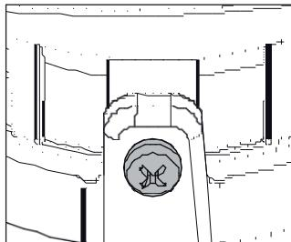
Затяните фиксирующий винт.
