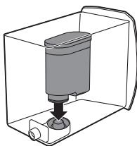
**15** Извлеките резервуар для воды из кофемашины, опустошите его, а затем установите фильтр в держатель в вертикальном положении.
