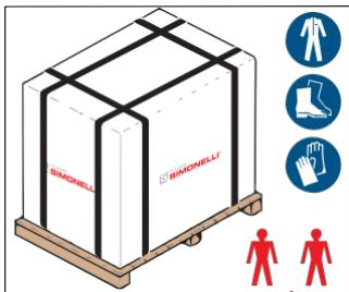
Машина транспортируется на паллетах. Внутри картонной коробки помещено несколько машин, коробка крепится к паллету монтажными полосами.
