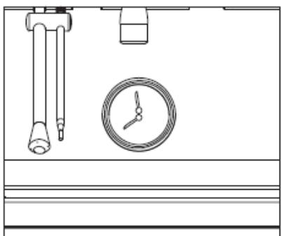
Уровень установленного давления отображается в нижней части манометра во время приготовления кофе.
